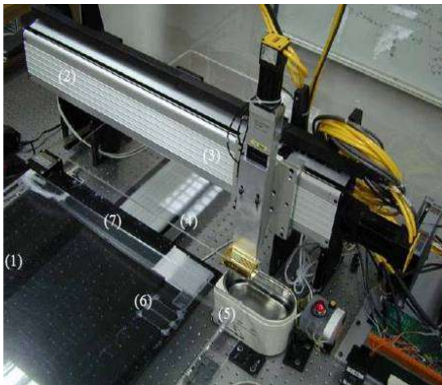
圖三 Brown型基因晶片系統，以目前的技術可以在一片22 mm ×75 mm大小的玻片上點印超過三萬點的探針。(1) X 軸平面(2) Y 軸(3) Z 軸(4) 針座(5) 超音波震盪器(6) 玻片(7) 384 孔盤。
