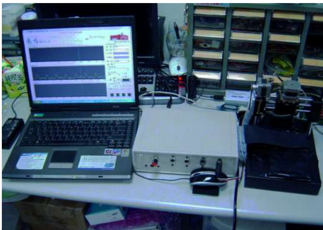
圖 3-9 多通道脈波分析系統及介面
