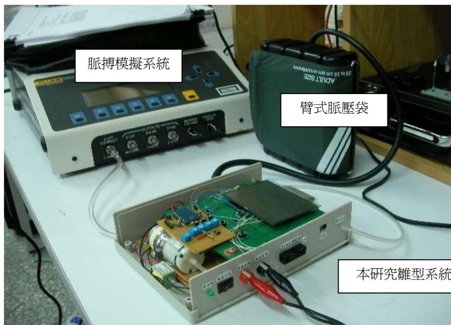
圖 19、實際系統測試及量測系統環境
