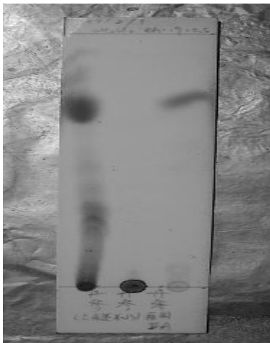
圖三 丹參水煮液之薄層層析結果。圖中三行，左邊為丹參乙醚萃取液，中間為丹參水煮液，右邊為丹參酮IIA溶液。
