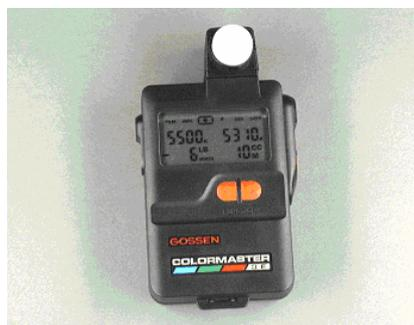
圖七 Gossen colormaster 3F 色溫表
