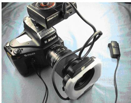
圖三 Nikon SB-21B 閃光燈與相機連接使用情形
